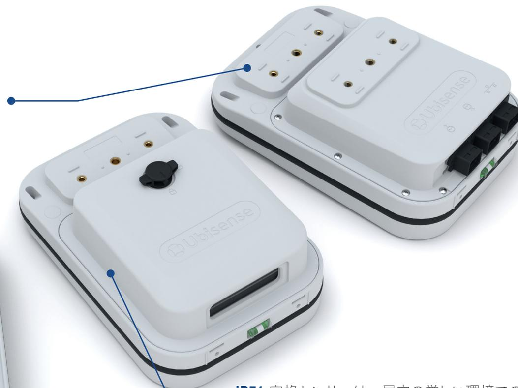
**IP54** 定格センサーは、屋内の厳しい環境での運用を想定しています。センサーの背面には2つのブラシが組み込まれたカバーが装着されており、ケーブルの入口から水しぶきやほこりがセンサーハウジング内に入るのを防ぎます。
