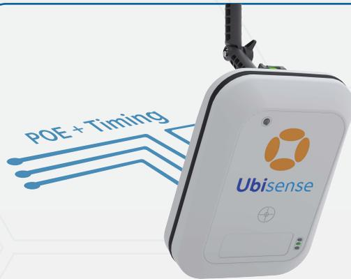
ミッションクリティカルなリアルタイムプロセス監視および制御アプリケーションでは、Dimension4はイーサネットネットワークに接続します。正確なタイミング同期のために、Cat5eタイミングケーブルをセンサー間で配線するか、TDUを使用します。
