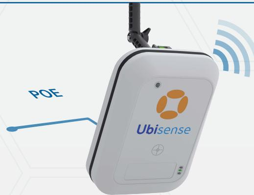
ケーブルの敷設がコスト的に難しく最高測位精度を要求しない環境では、Dimension4はワイヤレスバックホーモードで動作させることができます。センサーへの電力はローカルで供給され、測定データはすべてのセンサーが接続されているワイヤレスネットワーク全体で共有されます。
